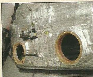
Die Dämmung spricht für sich: Die Lautsprecher sitzen auf schweren Rotgussringen, die direkt an das Türvolumen angekoppelt sind.
