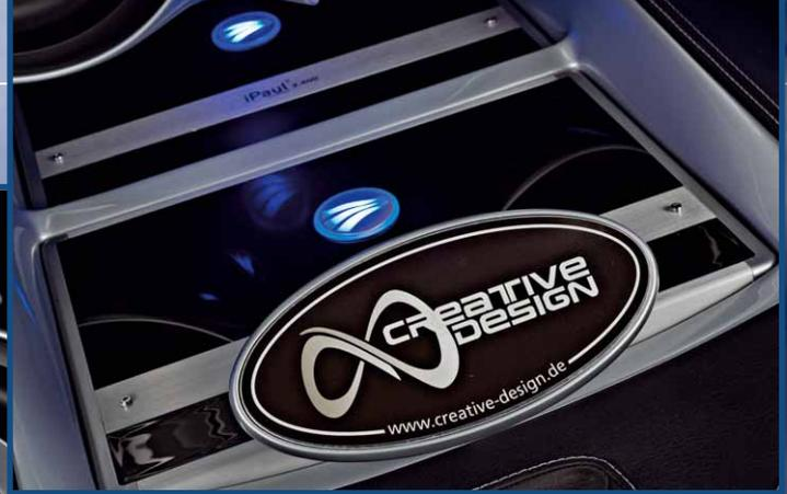
Hier liegt die Kraftzentrale: Eine Endstufe versorgt den Mittel-/Hochtonbereich, die andere die Tieftöner
