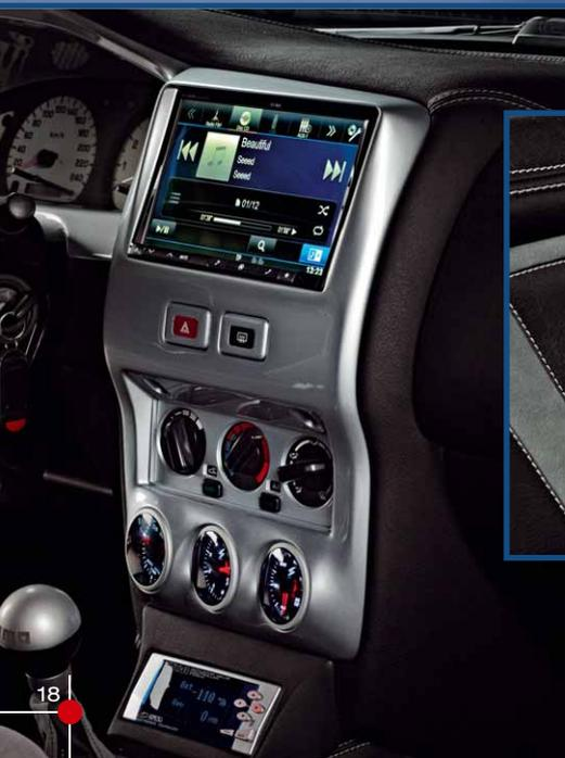
Für die Doppel-DIN-Steuerzentrale wurde die Lüftung umgebaut
